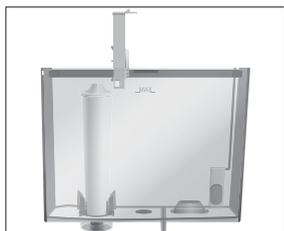
**i** L'efficacité du filtre s'épuise au bout de trois mois. Réglez sa durée de vie à l'aide du disque dateur placé sur le porte-filtre, dans le réservoir d'eau.
