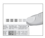
Vous pouvez déterminer la dureté de l'eau à l'aide de la languette de test Aquadur® fournie.
